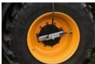
*Il sistema di controllo è disponibile sia per il solo asse posteriore, che per entrambi gli assi del trattore.*
